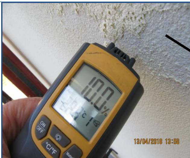
41. att. Kāpņu telpas bojātās ārējas virsmas mitruma mērījums.
