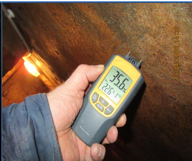
34. att. Ēkas pagraba pamata virsmas mitruma mērījums.
